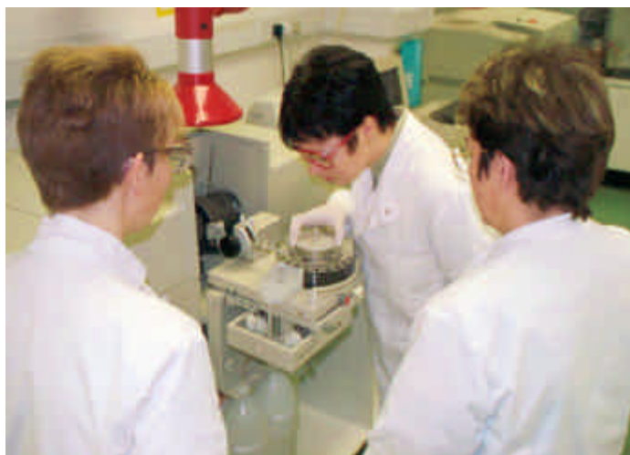
Хелен Сеймур, старший химик-лаборант компании «Хэлс ин бизнэс» (слева), наблюдает вместе с Мариной Солдатенко (справа) за тем, как Ольга Дурнева помещает пробы в автоматическую карусель атомно-абсорбционного спектрофотометра
