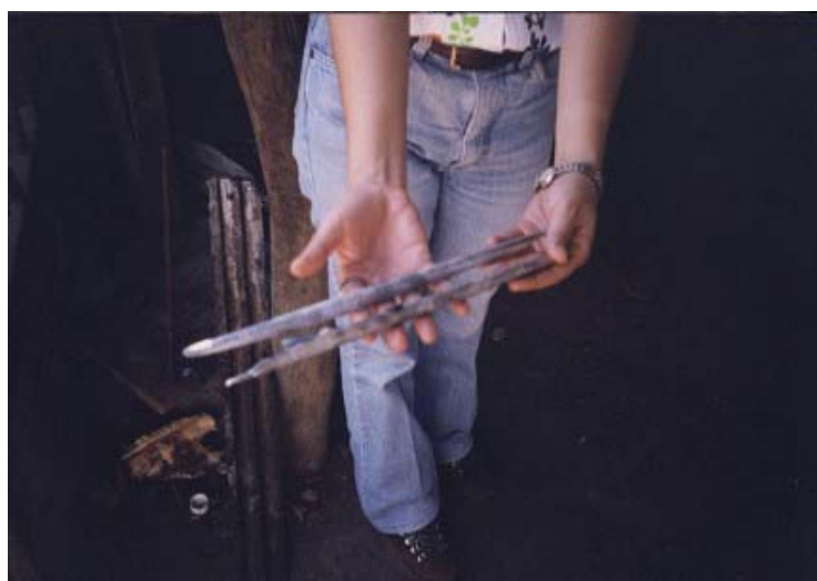
Figura 1.5. Barras de plomo de 1 pulgada de diámetro obtenido en los talleres de fundición del sector informal.
